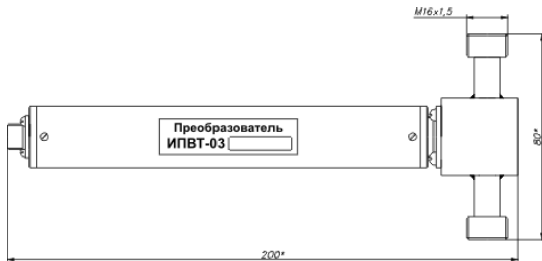
Рисунок Б2 Измерительный преобразователь ИПВТ-03-03-ПВ(-ПС)
