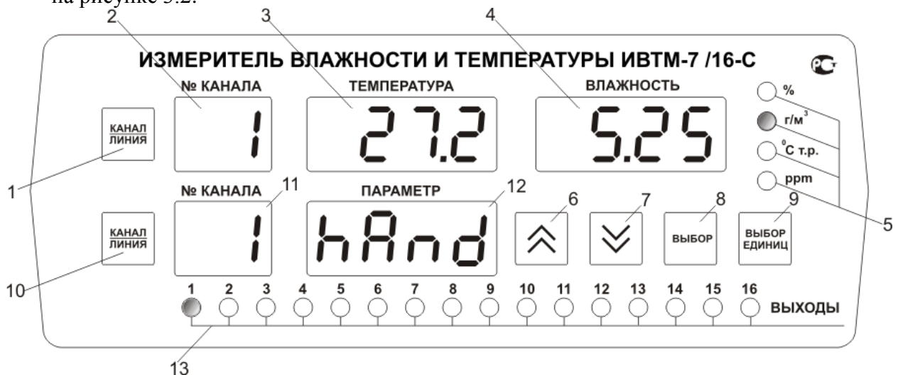
Рисунок 3.2 Вид лицевой панели прибора шестнадцатиканального исполнения
